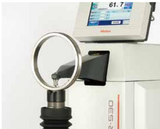
无需切断试样也能实现内壁的硬度试验。(所有型号)
