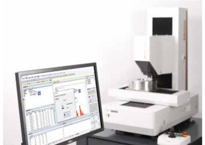
通过使用AVPAK，可以依据工件测量程序进行自动多点试验。
