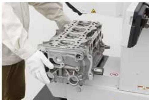
类似气缸体组件一般大小的工件也可以直接设置在工作台上。而且，可以试验最大100 kg的沉重工件。
