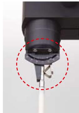
在检测器部分标准配置了安全装置。在检测器(竖向时)中对于 Z 轴方向的冲击，增加了冲击感应功能。同时，增加了在检测器的位置超过范围时自动停止的意外感知功能。意外感知功能检测到意外情况时，专用分析软件(ROUNDPAK)会提示错误，自动停止设备运行。
