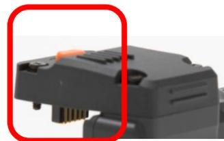
\*发射装置通过连接单元与测量工具相联, 测量工具与发射装置需各自使用独立电池。
