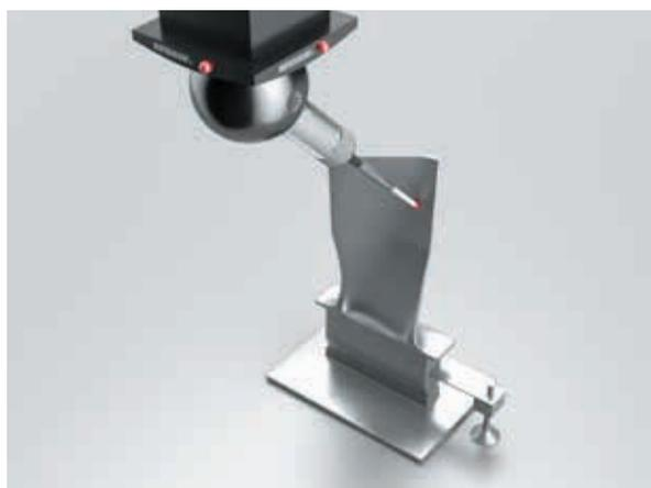
可使用小型、高精度扫描测头测量飞机发动机用叶片的截面。即使是对于铸件等落在误差较大的工件，也能快速稳定地进行测量。
