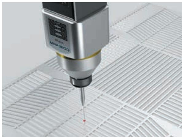
可使用低测力、高精度扫描测头，可以对分离器用精密模具进行曲面测量和截面测量。根据获得的测量点群进行3D误差分析和截面形状分析。
