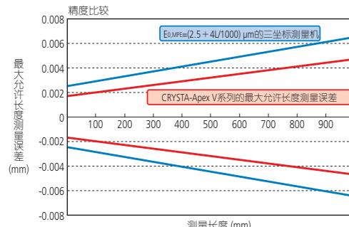
\*1：为 JIS B 7440-2(2013) 制定的三坐标测量机的精度标准。该标准中包含“不确定性”。与不考虑不确定性的标准【JIS B 7440-2(1997)】相比，标记的值(样本规格参数)即使相同，但以新标准表示的机器在性能上要好得多。
