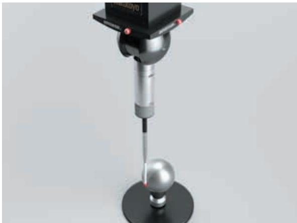
可使用小型、高精度扫描测头进行人工关节的自由曲面测量，根据取得的测量点群进行3D误差分析。
