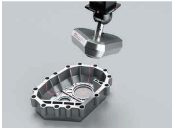
与接触式测头(扫描)相比，使用非接触式激光测头能够大大缩短测量时间。由于从3个方向的批量扫描同时测量上表面和内侧，因此姿势改变的次数少，即使形状复杂也能高效测量。
