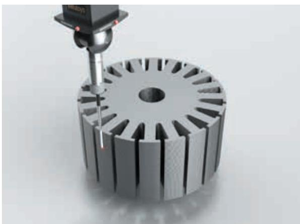
可测量层叠的电机铁芯的直线度和截面形状等。支持立体工件的测量，如侧面或任意高度的尺寸测量等。
