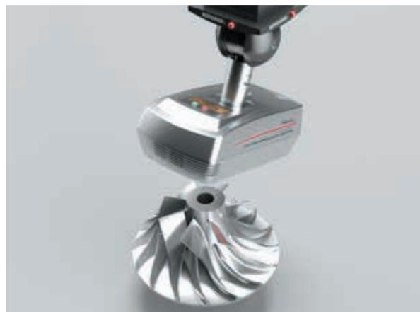
可使用具有高鲁棒性能、可抑制多重反射的非接触式激光测头测量叶轮。它具有与接触式测头同等的精度和优异的形状再现性。
