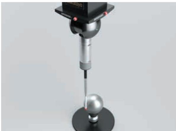
可使用小型、高精度扫描测头进行人工关节的自由曲面测量，根据取得的测量点进行3D误差分析。
