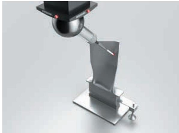
可使用小型、高精度扫描测头测量飞机发动机用叶片的截面。即使是对于铸件等潜在误差较大的工件，也能快速稳定地进行测量。
