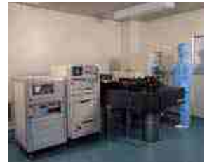
长度基准用633nm碘分子吸收线 波长稳定的He-Ne激光装置
