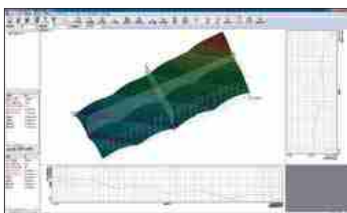
由QVH4进行的丙烯酸有机玻璃透镜测量实例
